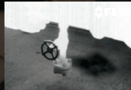
METHANE LEAK AT NATURAL GAS FACILITY SITE
